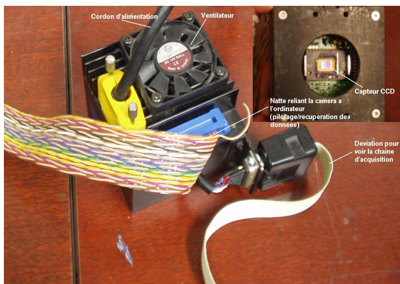
Figure 1 – image du boîtier caméra. Pour ce TP une optique est également présente devant le capteur afin de pouvoir faire des images.
