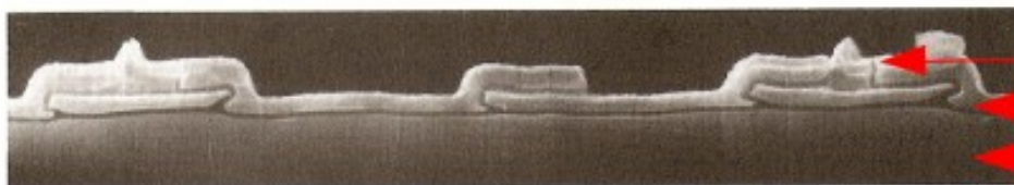
Vue en coupe d'un CCD 3 phases
