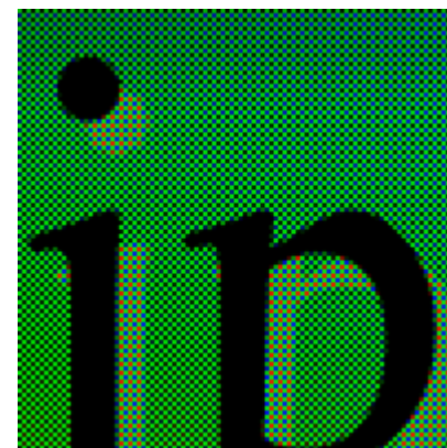
Image obtenue par le filtre de Bayer
