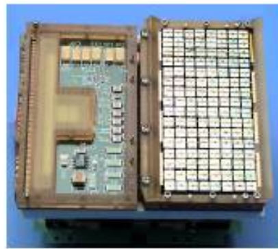
Module du plan de détection du Swift -BAT - Détecteurs de CdZnTe (CZT)
