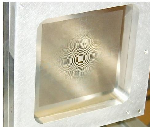
Réseau primaire carré de 80 mm gravé dans une feuille d'acier de 80  $\mu\text{m}$  servant aux tests optiques.
