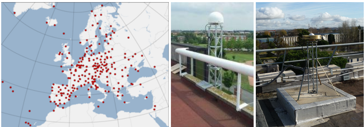
FIG. I.4: Stations du réseau permanent européen EUREF, ayant pour but de définir le "système de référence terrestre européen" (ETRS89). A droite, stations GPS du réseau EUREF à Toulouse : à Météo France-CNRM et au CNES.
