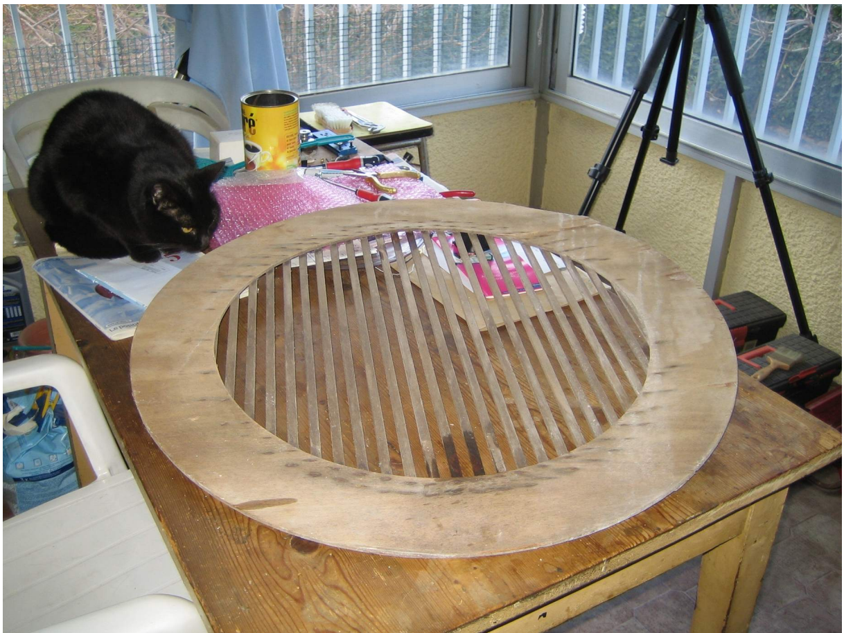
FIG. III.20 – Grille utilisée pour la calibration astrométrique de PISCO2 (la chatte de René (“Pomponette”) semble intriguée...).
