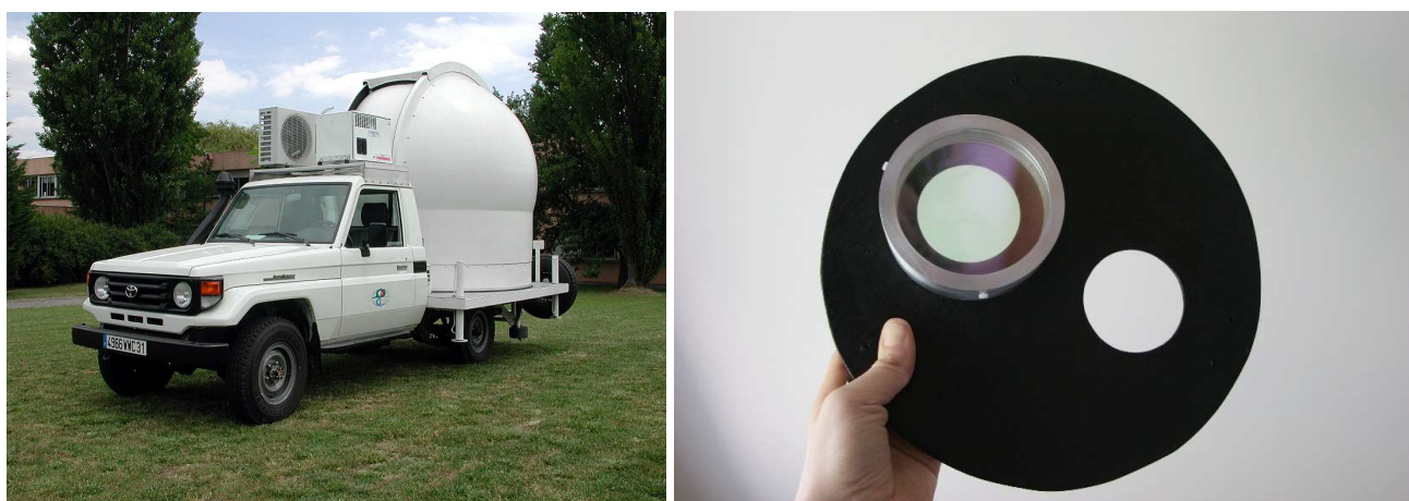
FIG. I.23 – Préparation à l'OMP pour la prospection de site en Lybie avec un DIMM mobile (F. Querci et coll.) (à gauche). A droite : un prisme est placé sur une des ouvertures à l'entrée du télescope (DIMM de l'ESO).
